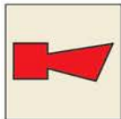
Horn, fire alarm 6003 EE, GG & JJ
