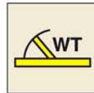
'B' Class watertight fire door
