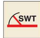
'A' Class semi-watertight fire door
